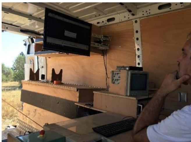
Passage caméra dans un piézomètre
