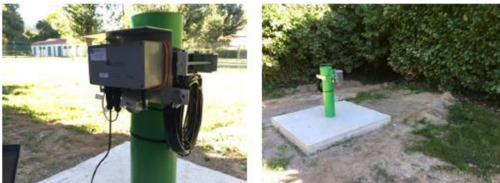
*Piézomètres du Galeizon et instrumentation pour la télétransmission des données*
