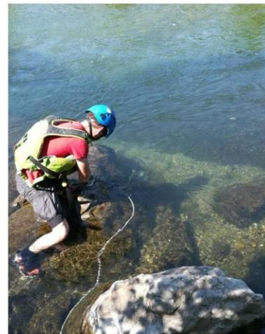
*Injection de la fluorescéine, mise en place de la sonde fluorimètre et du préleveur automatique dans le Gardon*
