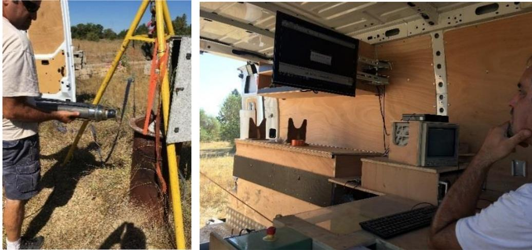
*Passage caméra dans un piézomètre*
