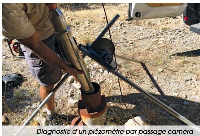
Diagnostic d'un piézomètre par passage caméra
