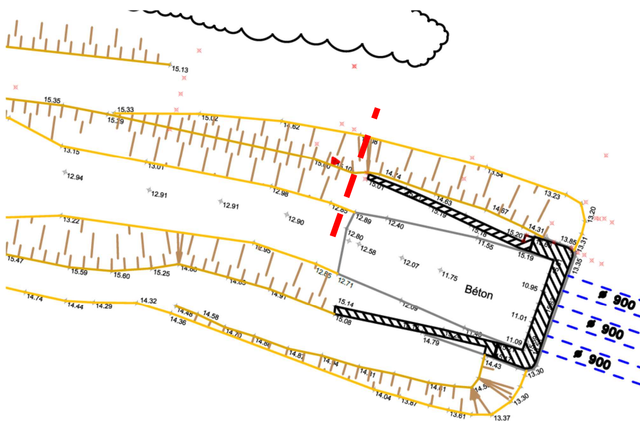
Figure 45 : Raccordement au siphon (zone ouest)
