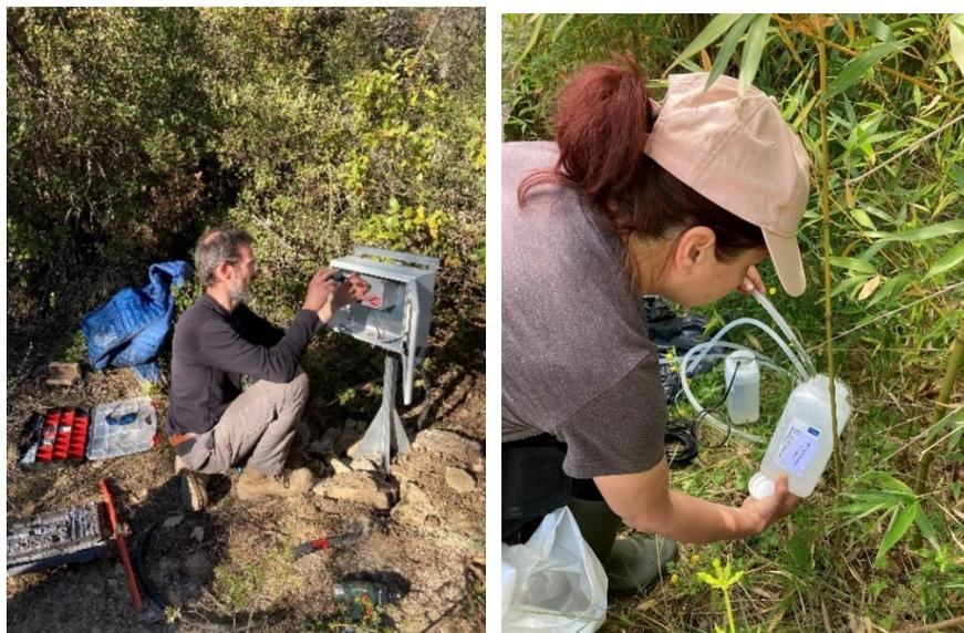
*Installation du dispositif de télétransmission d'un piézomètre (Tetraèdre) et prélèvement à Carabiol (Hydriad)*
