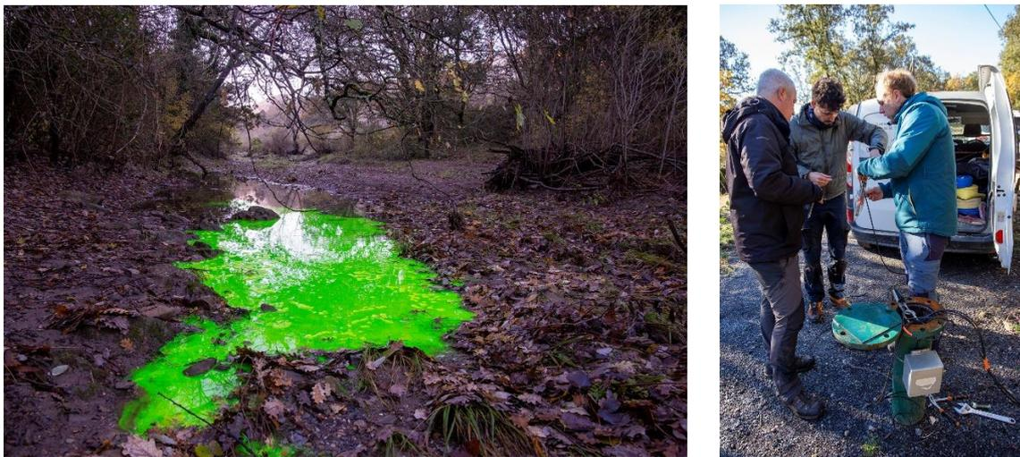
*Traçage des pertes de l'Avène en décembre 2022 et relèvement d'un fluocapteur sur le piézomètre du Mas des Roberts (Berga Sud)*
