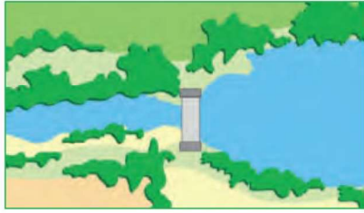
Ouvrage infranchissable et « effet retenue »
